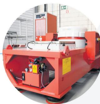
Mesa de vibração de alta performance para ensaios em equipamento: vibrações, fadiga e choque. Ambiente ISO 5.
