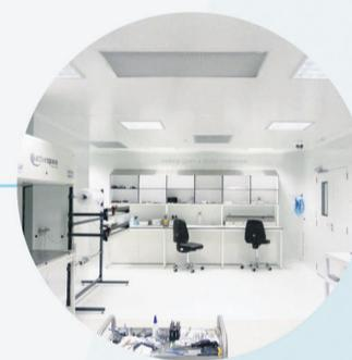
Sala Limpa ISO 7 para ensaios e montagem de componentes em ambiente controlado. Equipada com módulo laminar Telstar ISO 4.
