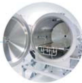
Câmara de ciclos térmicos para ensaios: ciclos, fadiga e vácuo. Ambiente controlado e ISO 8.
