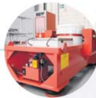
Mesa de vibração de alta performance para ensaios em equipamento: vibrações, fadiga e choque. Ambiente ISO 5.
